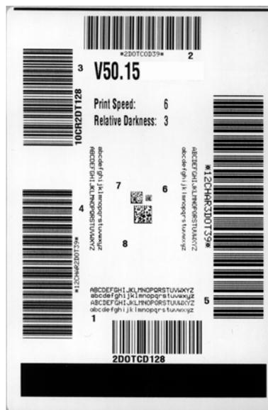
4. 図 19 および表 20 を参照してください。テスト・ラベルを見て、どのラベルがアプリケーションに最適な印刷品質であるかを判断します。バーコード検証器がある場合は、バーコード検証器を使用してバー/空白部分を測定し、印刷のコントラストを計算します。バーコード検証器がない場合は、目視およびシステム・スキャナを使用して、このセルフ・テストで印刷されるラベルに基づいて最適の濃度設定を選択することをお勧めします。
