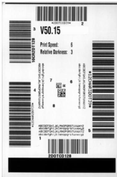
4. 図 3 および表 5 を参照してください。テスト・ラベルを検査して、どのラベルがアプリケーションに最適な印刷品質であるか判断します。バーコード検証器がある場合は、バーコード検証器を使用してバー / 空白部分を測定し、印刷のコントラストを計算します。バーコード検証器がない場合は、目視およびシステム・スキャナを使用して、このセルフ・テストで印刷されるラベルに基づいて最適の濃度設定を選択することをお勧めします。
