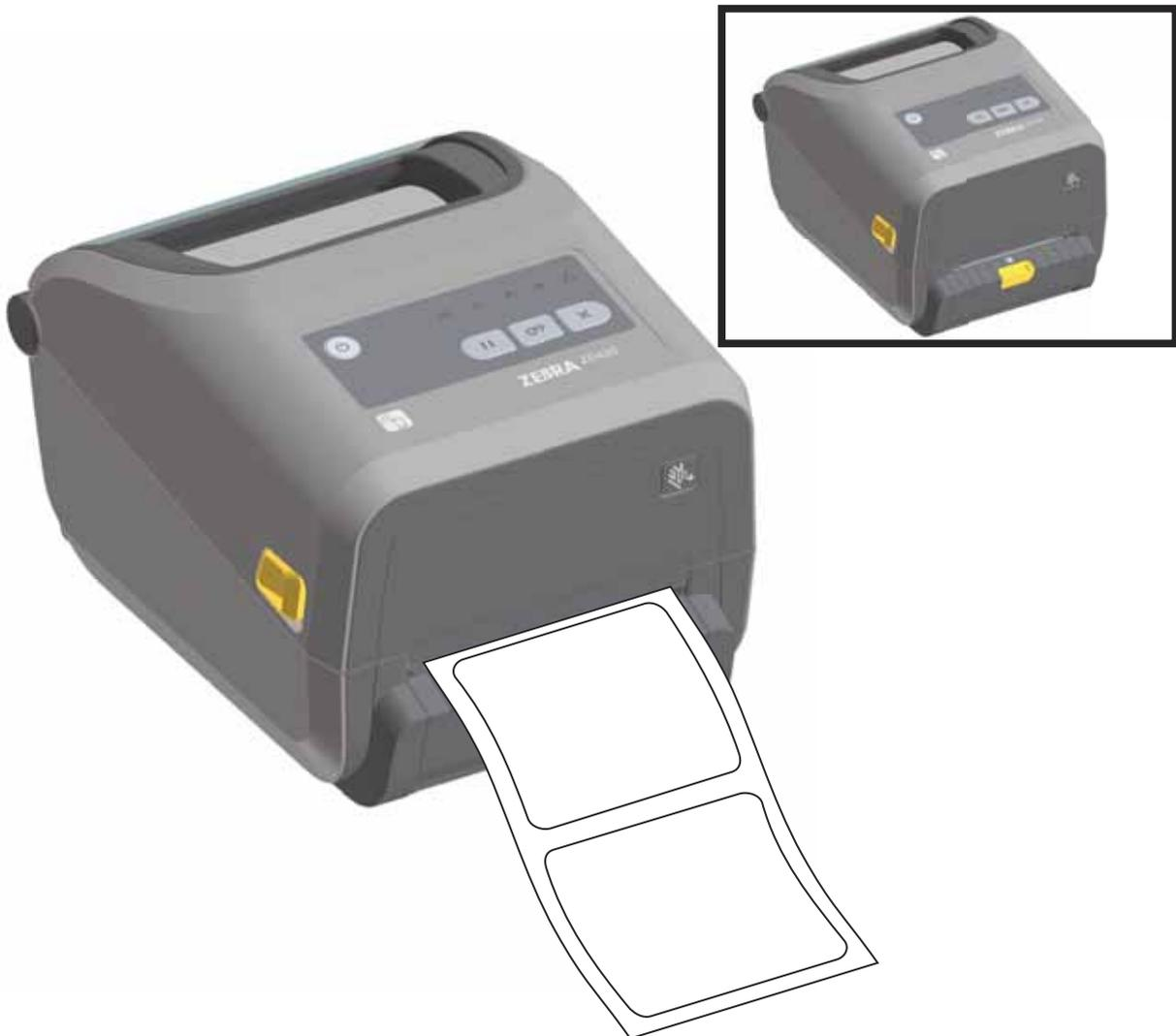
2. ライナーをプリンタの上部に持ち上げます。ディスペンサ・ドアの中央にある金色の止め金をプリンタから引き離すとドアが開きます。
