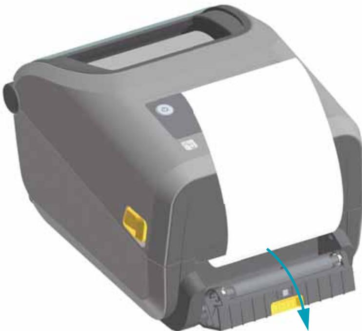
3. ディスペンサ・ドアとプリンタ本体の間にラベル・ライナーを挿入します。
