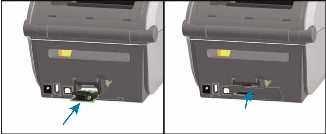
1. モジュールのアクセス・ドアを取り外した状態で、シリアル・ポート・モジュールをスライドさせてプリンタに挿入します。回路カードがアクセス・ドアの内側のへりを越えるまでカードをゆっくりと確実に押し込みます。
