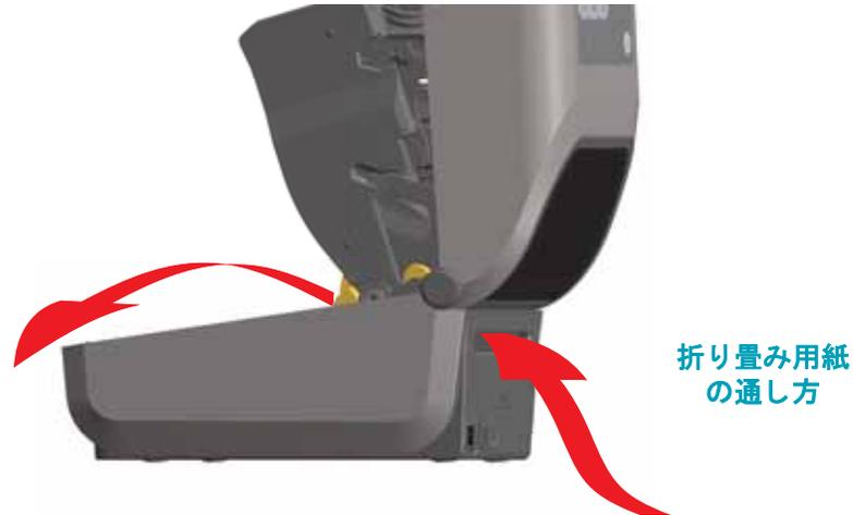
2. 用紙ガイドの停止位置を金色のつまみを使って調整します。折り畳み用紙を1枚使って停止位置を設定してください。用紙ガイドの幅を広げるには、つまみを向こう側に回します。用紙ガイドの幅を狭くするには、つまみを手前に回します。
